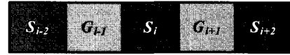
그림 3. 색상신호 S_i 화소에서의 일차원 패턴 Fig. 3. One dimensional neighborhood pattern in a chrominance pixel S_i .
