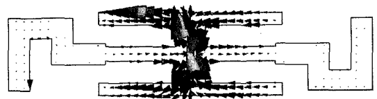
(b) 5.50 GHz에서 안테나의 전류 벡터 (b) Current vector of an antenna at 5.50 GHz
