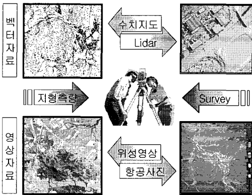
그림 5. 수치표고모형 취득 방법 Fig. 5. How to acquiring Digital Elevation Model
