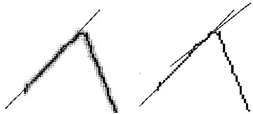
그림 6. N 픽셀 경계선에 의한 국부적인 최대값 억제 효과 Fig. 6. Local maxima suppression using N-pixel wide edge
