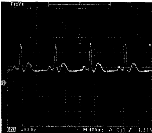
그림 10. 심전도 신호 발생기로부터 출력된 오실로스코프 상의 심전도신호 형태 Fig. 10. The output ECG signal from ECG signal generator by oscilloscope.
