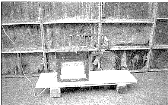
사진 4. 테이터로거를 이용한 콘크리트 내부 수화열 측정
