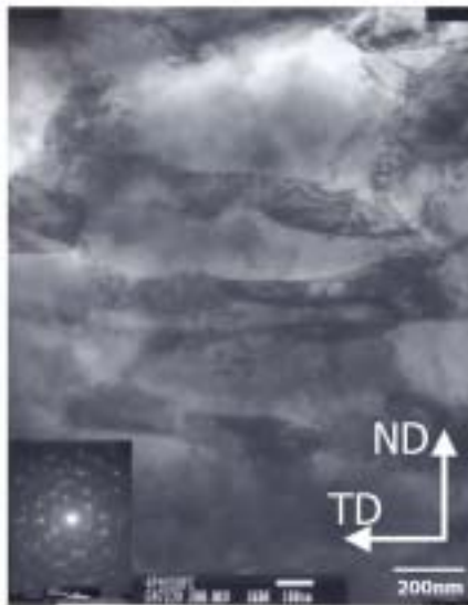
그림 12. 무산소동의 4 pass ARB후의 단면조직사진
