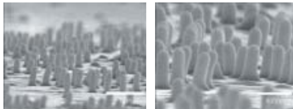
그림 29. SAM으로 개질된 AAO Plate를 이용하여 제작된 PDMS Replica
