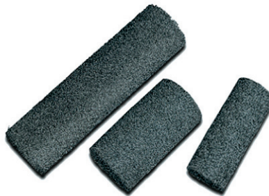
그림 7. 자전연소법으로 제조된 다공질 Ti-Ni 합금
