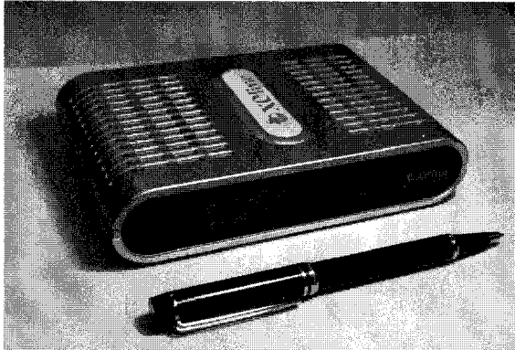
■ ■ 그림 1 _ 24Mbps급 XPLC21 칩이 내장된 PLC 모델
