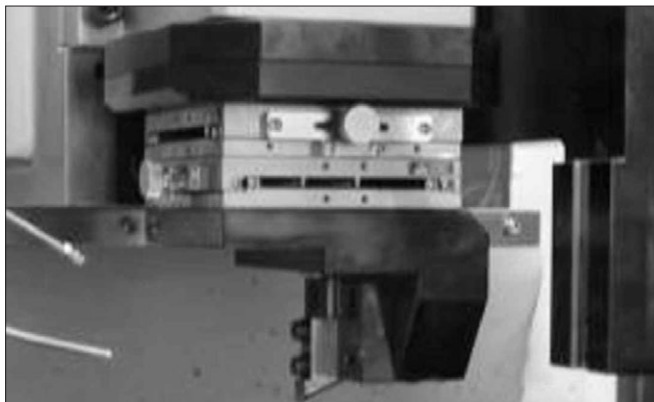
그림 7. NC바이트 선회 장치(중 방향)
