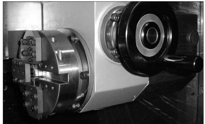
그림 6. 바이트 선회 장치(횡 방향) : 수동 선회
