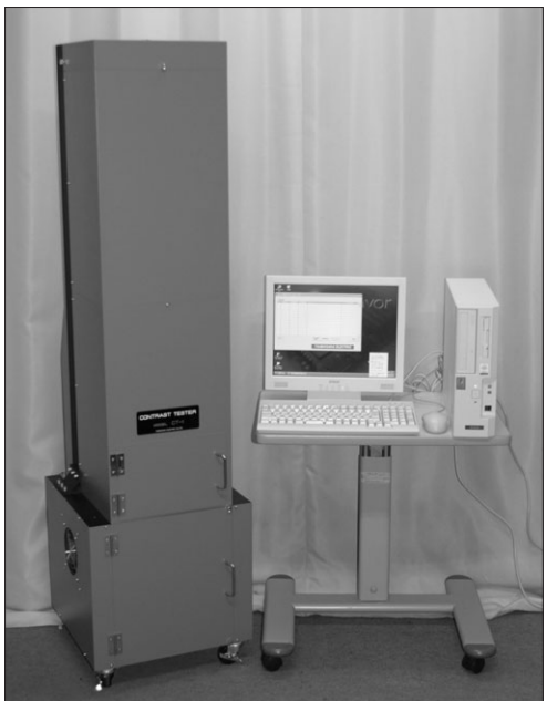
▶LCD Color Filter RGB Contrast Tester(모델명: CT-1). LCD의 RGB Color Filter용 고품질 도료의 품질관리에 필수품이며 잉크의 입자상태, 내구성의 균형을 측정하는 장비
