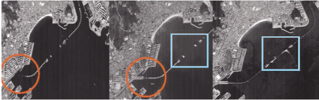
부산광안대교 공사 진행에 따른 해안 시설물 변화탐지
