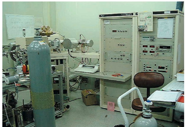
<그림 3> 한국표준과학연구원에서 공기 조성을 측정하기 위하여 사용한 정밀가스질량분석기
