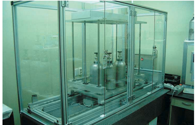
<그림 2> 건조공기 측정의 기준이 되는 표준 공기(일차표준가스)를 중량법으로 제조하기 위한 실린더 자동 질량 측정 장치
