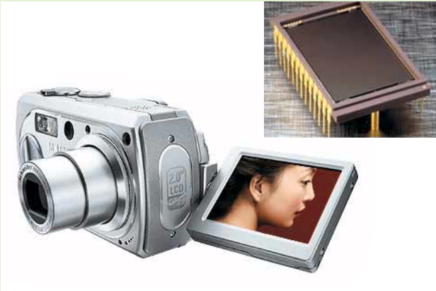
CCD 칩과 CCD 칩을 사용하는 디지털 카메라
