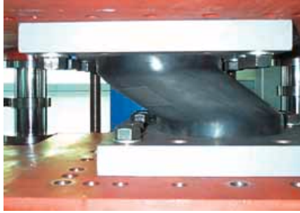
〈그림 2〉 지진격리장치는 고무와 철판의 적층구조에 금속이 중앙에 들어 있는 구조로 되어 있기 때문에 (왼쪽) 수직방향으로는 강한 강성을 가지면서도 수평방향으로 유연하게 거동한다(오른쪽).
