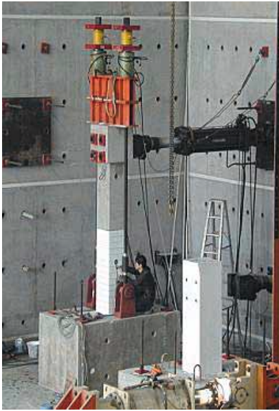
〈그림 4〉 기둥의 부분구조계 실험 장면
