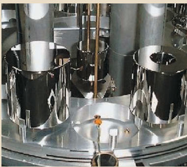
BIPM에 있는 자동 저울 장치로서 진공 및 공기 중에서 작동할 수 있음. 왼쪽과 오른쪽의 가공품은 질량과 표면적이 같지만 부피는 왼쪽 것이 크다.
