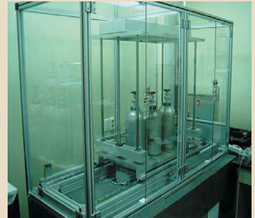
건조공기 측정의 기준이 되는 표준공기(일차 표준가스를 중량법으로 제조하기 위한 실린더 지동 질량측정장치)
