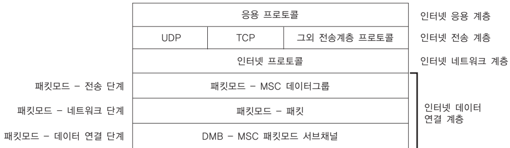
그림 3. 패킷 모드 서비스 컴포넌트에서의 IP 터널링을 위한 프로토콜 스택
