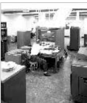
<그림 1> 미국 로렌스 리버모어 연구소에 있던 IBM 704 컴퓨터 - 부동소수점 연산 장치를 내장하고 있는 최초의 상업용 컴퓨터로 초당 약 5천 번의 부동소수점 연산 능력을 가짐
