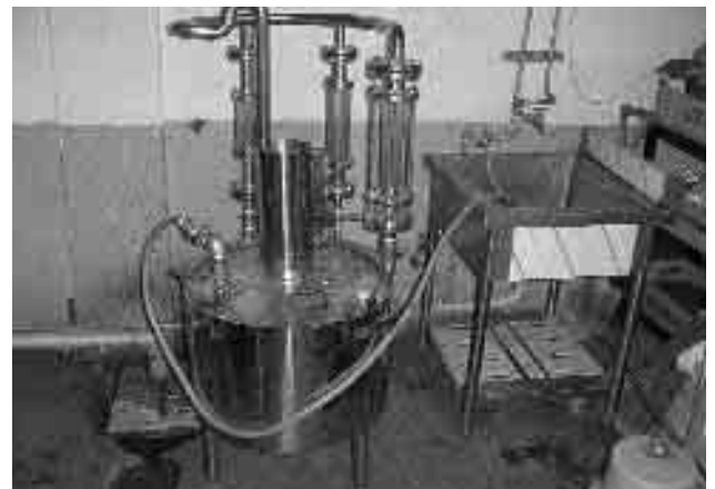
그림 3) 급수전을 이용한 계량기 시험장면
