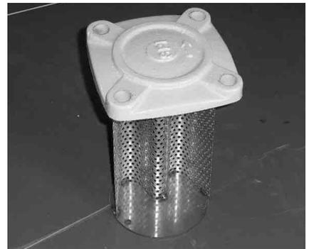
그림 4) 기존 Strainer 거름망
