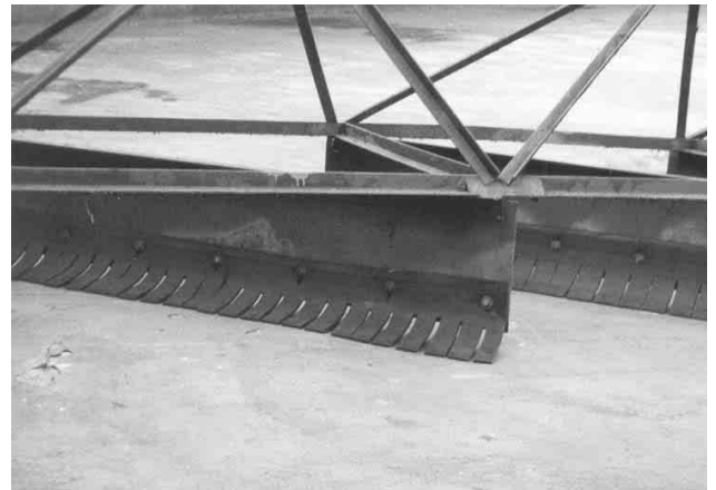
그림 3) 스크레퍼 브러시형 Rubber 설치 후 매끄러운 바닥면
