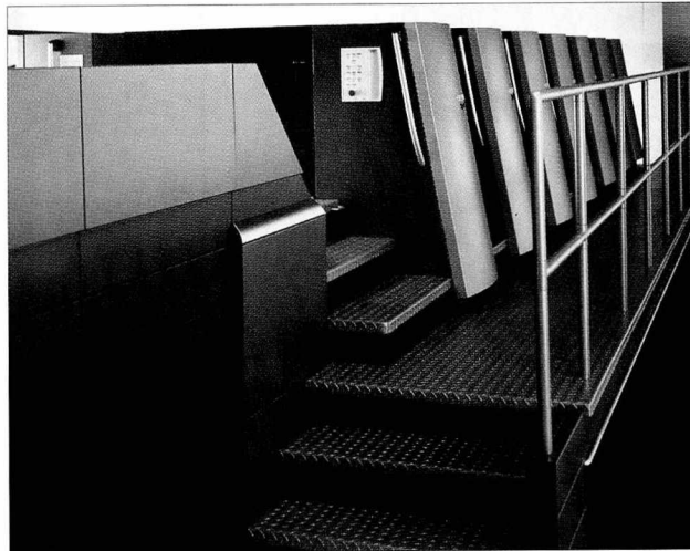
하이델베르그사가 출시한 차세대 매엽 오프셋 인쇄기 스피드마스터 XL105. 스피드마스터 XL105는 기존의 인쇄기보다 큰 75×105cm의 용지 규격과 시간 당 1만8천통의 최대 속도를 제공한다.
