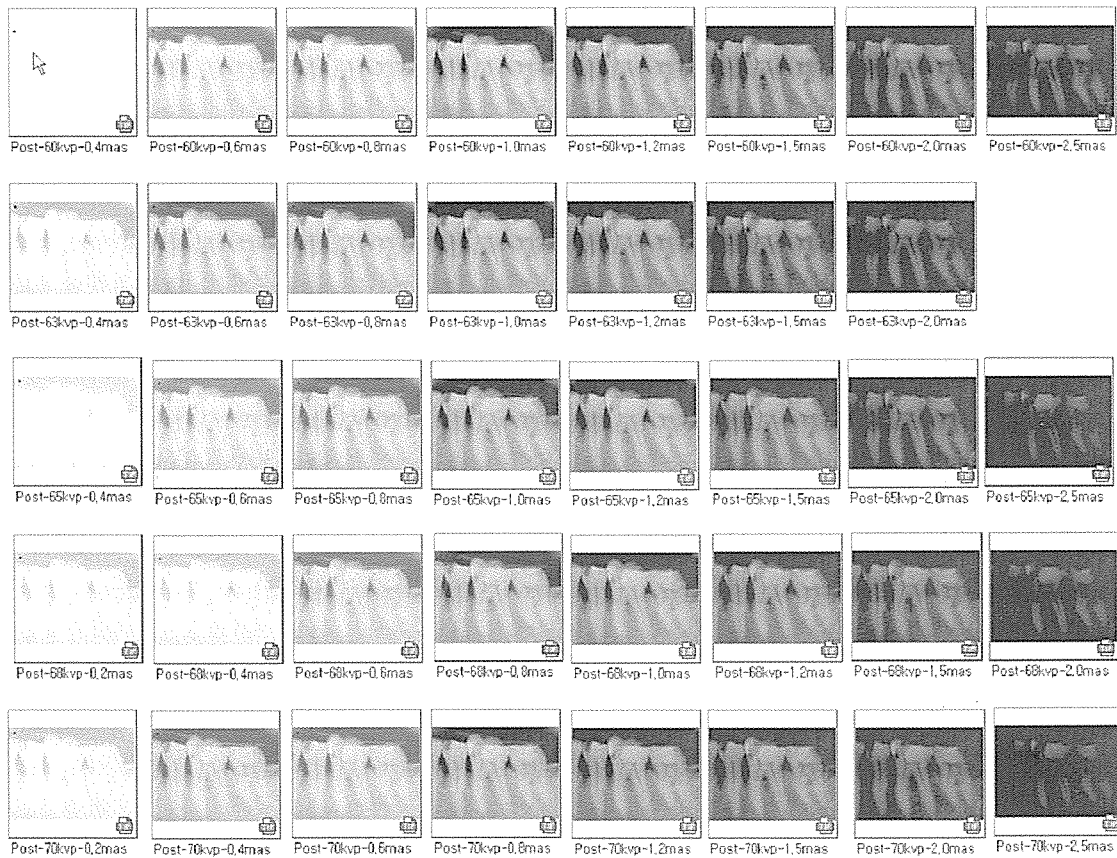
그림 9. 다양한 관전압과 노출시간에 따른 건조 두개골의 하악구치부 영상
