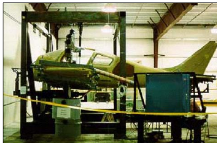
그림 4. 복합재료 전 기체 피로시험 [7]
