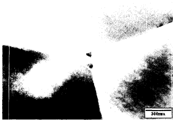
Fig. 4. 900°C에서 소결된 PZT-PNN + 3mol%ZnO+2mol%CuO의 TEM bright field image.
