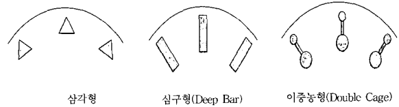
그림 4 표피효과를 고려한 기동특성 개선형 회전체 도체 구조
