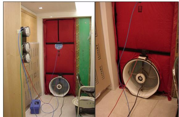
그림 2. Blower-door Method에 의한 기밀성 측정 장면
