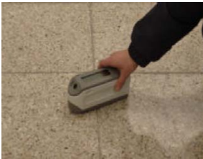
그림 16. 분광측색계로 병실내 재료의 물성값을 측정하는 모습
