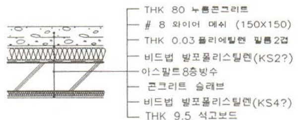
그림 3. 기존외단열공법 표준상세도, 대한주택공사
