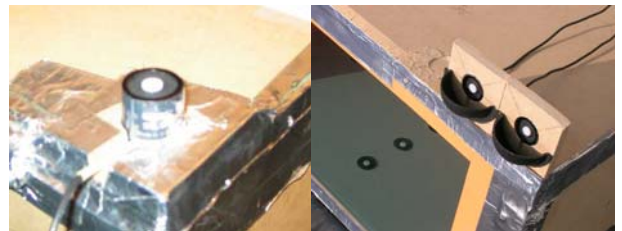
그림 12. 외부 설치된 조도계(좌: 수평면, 우: 수직면)
