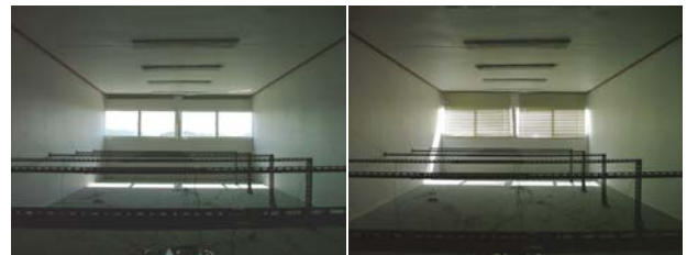
그림 6. Mock-up 실험실 내부 전경 일반창(좌)일 경우와 블라인드를 설치한 경우(우)
