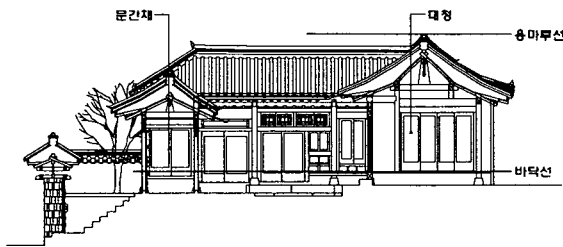
그림-5 북촌도시한옥의 단면모습(가회31-4) 출처 : 북촌가꾸기 기본계획 한옥실측도면집
