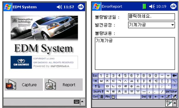
그림 9. 무선랜과 카메라 장착 PDA를 이용한 불량관리 시스템.
