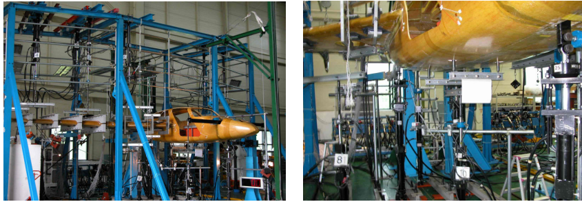
<그림 10> 정하중 구조 시험
