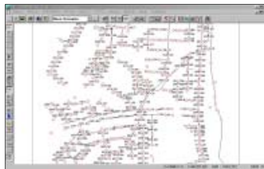
FIGURE 5. XP-SWMM 모형을 이용한 하수관망 구성 현황
