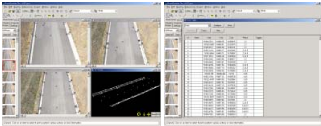
FIGURE 10. 정량화된 도로선형 및 도로시설물과 추출된 상좌표
