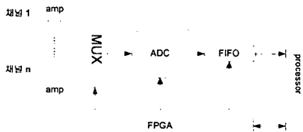
그림 3. I/O모듈의 구성도 Fig. 3 Block diagram of I/O module
