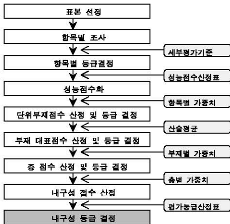
Fig 2. 콘크리트 내구성 평가 순서
