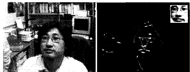
그림 10. 검출된 얼굴영역 및 얼굴요소 위치 결과. Fig. 10. Detection result of face area and feature locations.
