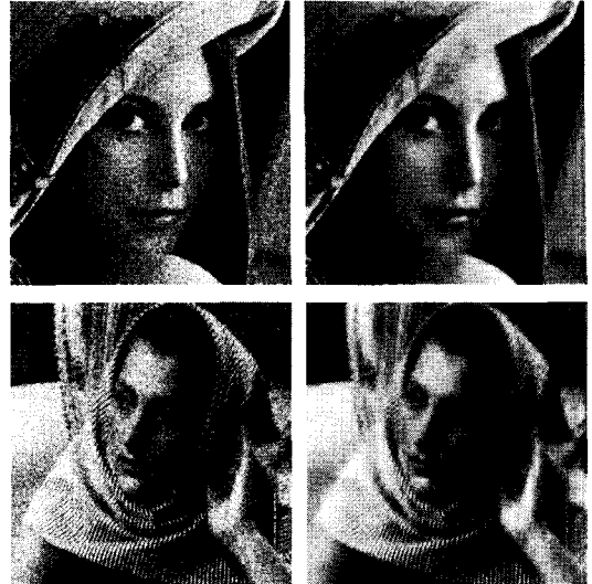
그림 5. \sigma_n=20 때, Lena 및 Barbara 영상에 대한 다양한 잡음 제거 방법의 결과 확대. 왼쪽 위 : Lena의 잡음 영상, 오른쪽 위 : Lena의 잡음제거 결과(31.06dB), 왼쪽아래 : Barbara의 잡음 영상, 오른쪽 아래 : Barbara의 잡음제거 결과(28.73dB).
