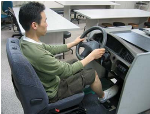
그림 3. 측정 센서를 부착하기 전 모의자동차에 탑승하여 운전자세와 의자의 위치를 조절하는 모습
