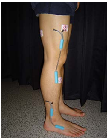
그림 4. 표면전극과 전자 동작측정기를 부착한 모습
