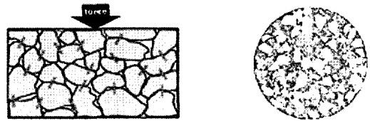
그림 4. SMA(Stone Mastic Asphalt)의 기본개념
