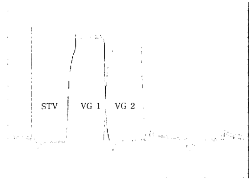
그림 8. A model의 10 °C 부근에서의 shift register 출력 파형.
