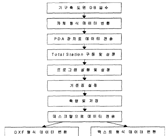
그림 4. 측량 장비를 이용한 매핑 시스템의 작업 흐름도
