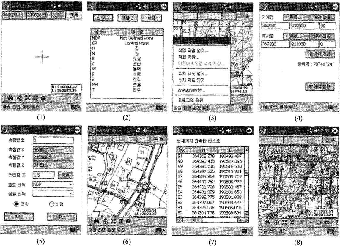
그림 6. 토털스테이션과 연계한 PDA 매핑 시스템의 실행 화면
