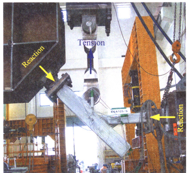
그림 3. 실험체 가력 및 변위계 부착상황
