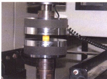
그림 14. 고무시편을 실험장비에 설치한 모습
