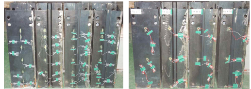
Photo 1 철근변형률 게이지 부착 전경
