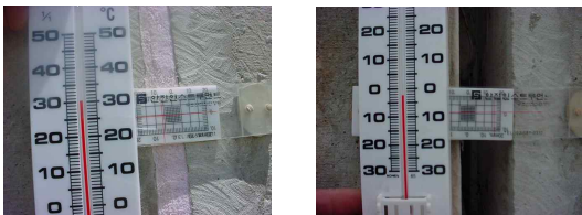
① 30°C 좌6mm'02.6.21pm01 ⑤ -3°C 우16mm'03.1.15am05 Fig. 7 33°C 변화 시 조건1의 유격변화
