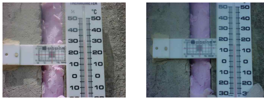
③ 31°C 좌1mm'02.6.21pm02 ④ 15°C 우1mm'02.6.21am06 Fig. 6 16°C 변화 시 조건2의 유격변화
